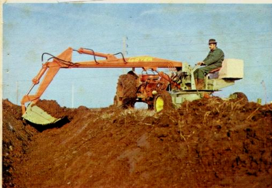
La stabilité absolue de la machine est assurée par les stabilisateurs hydrauliques
